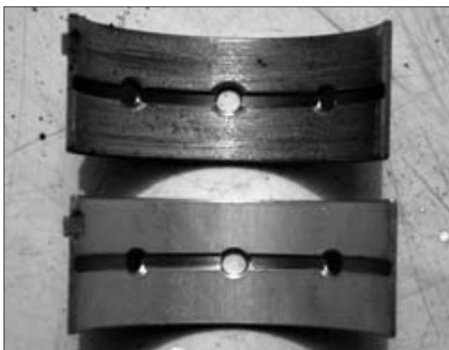
Dole polovina nového ložiska, nahoře polovina opotřebovaného ložiska se známkami nedostatečného mazání a vytrhávání výstelky ložiska.
