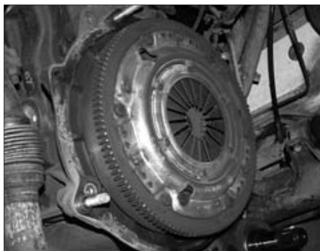
Ozubený věnec zkontrolujte buď po demontáži převodovky nebo otvorem, který vznikne demontáží startéru. Při kontrole můžete opatrně pootáčet motorem a zkontrolovat, zub po zubu, a tak přesně zjistit stav opotřebení.
