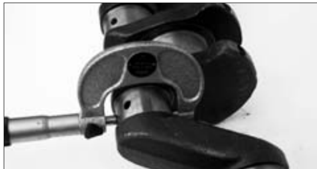
Opotřebení klikové hřídele změřte na hlavních a ojníčích čepích mikrometrem. Posuvné měřítko je pro toto měření nepřesné a můžete ho využít jen k orientačnímu měření.
